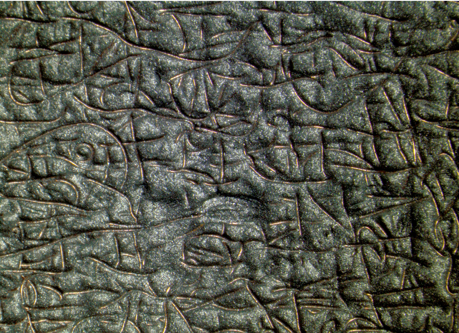
Textile Hochleistungsmaterialien: Gestickte Elektrodenstruktur für Li-Ionen Batterie. © Universität Innsbruck
