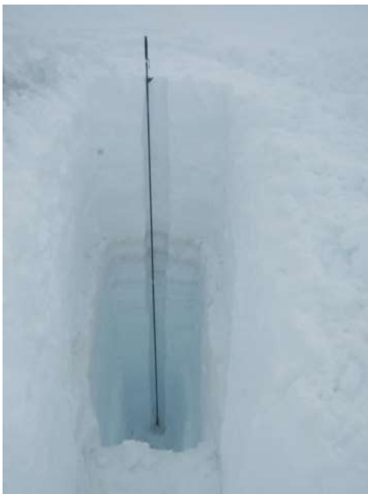
Abbildung 15: Schacht TE mit zwei Saharastaubhorizonten auf 280 cm (27.04.) und 305 cm (30.04.) oberhalb der Eisoberfläche von 2012. Foto: Christian Wild, 03.06.2013.
