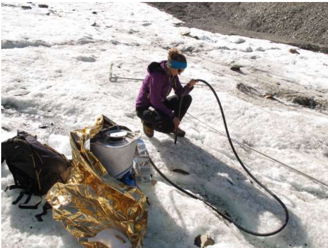
Abbildung 22: Bohren eines Ablationspegels. Foto: Rainer Prinz, 28.08.2014.
