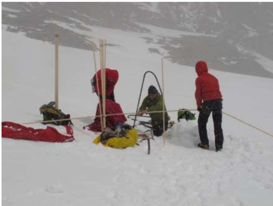
Abbildung 27: Bohren von Ablationspegeln am KWF. Foto: Rainer Prinz, 10.07.2014.
