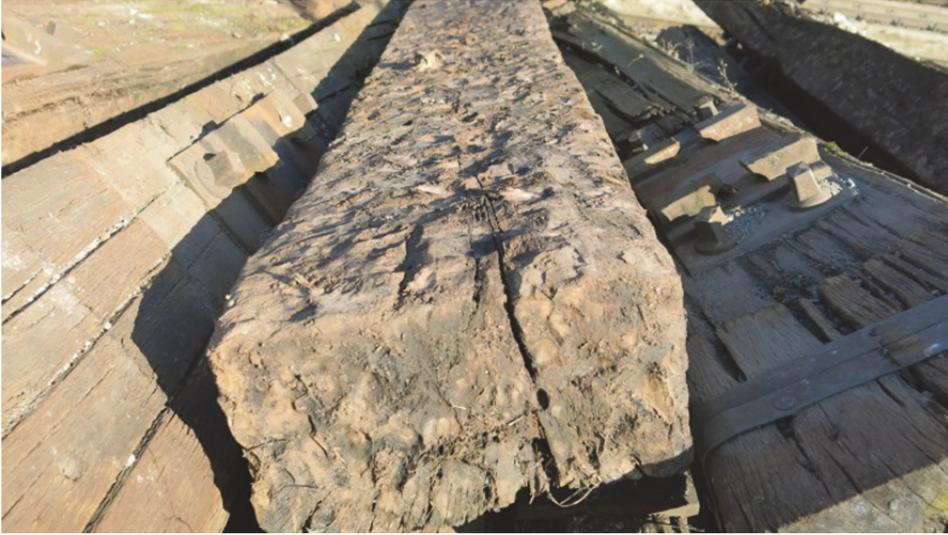
**Abbildung 33: Unterseite einer ausgebauten ehemals sehr gut eingefahrenen Holzschwelle im Bereich Braz**
