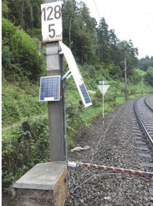
**Abbildung 46: Messbasis mit Messkiste, Stromversorgung und Wetterstation für Verschiebemessung**
