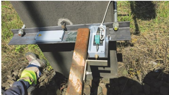
**Abbildung 48: Messbasis für Verschiebemessung**
