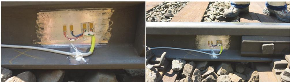
**Abbildung 52: Applikation der DMS mit Temperaturkompensationsplatte**
