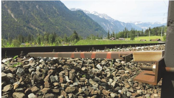
**Abbildung 47: Messstange für Verschiebemessung**
