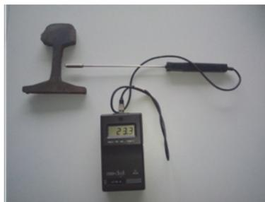
Abbildung 139: Ama-Digital Messgerät
