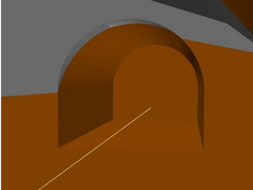
Abbildung 3.9: Teiltunnelausbruch im Baugrundsichtenmodell
