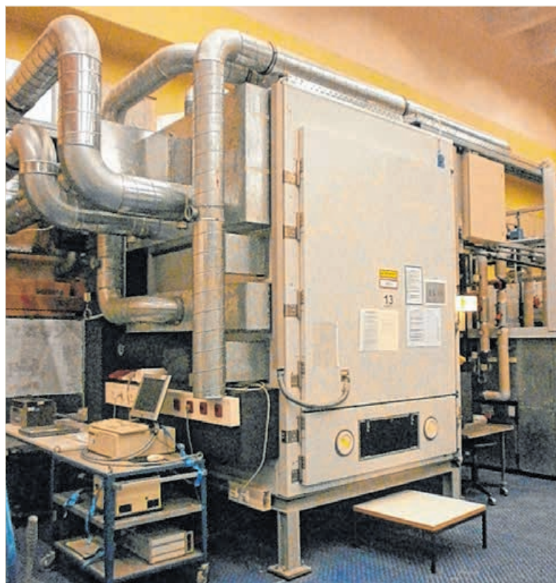
Sonnen-Simulatoren am Helmholtz-Zentrum in München zur realistischen und kontrollierten Untersuchung der Auswirkungen von UV-Stress. Foto: A. Hartmann
