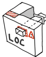
Abbildung 2.3: Schemaskizze LOC – LOC „falsch“ aufgrund von Bauteilkollisionen. [18]
