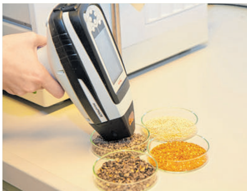
Mit der Nahinfrarotspektroskopie werden die Proben minimalinvasiv und zerstörungsfrei gemessen.
