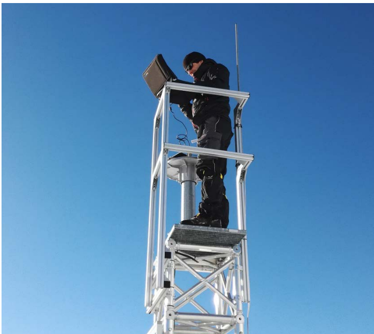
Abbildung 31: Der Pluviometer ist defekt und muss eingeschickt werden. Foto: Rainer Prinz, 03.12.2019.
