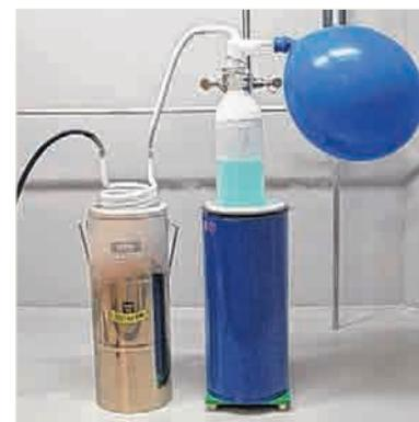
Herstellung von Flüssigsauerstoff. Gasförmiger Sauerstoff wird durch die Glasspirale geleitet, die in flüssigen Stickstoff getaucht ist.
