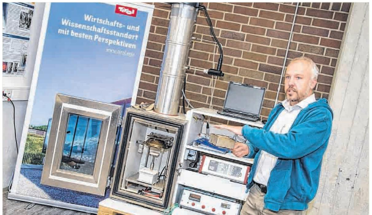
Ein am Arbeitsbereich Holzbau entwickeltes Messgerät ermöglicht den Innsbrucker Forschern um Prof. Roman Lackner vom Arbeitsbereich Materialtechnologie (im Bild), das Abbrennen von unterschiedlichen Hölzern sehr genau zu studieren. Die Ergebnisse fließen auch in das Simulationstool ein, mit dem später Bauingenieure den sicheren Einsatz von Holz in Gebäuden planen werden können.
