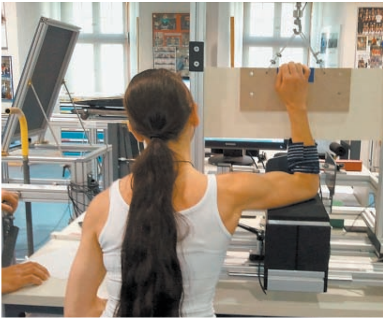
Mit einer von Marc Philippe entwickelten Testanordnung wurde die Kraftübertragung gemessen.
