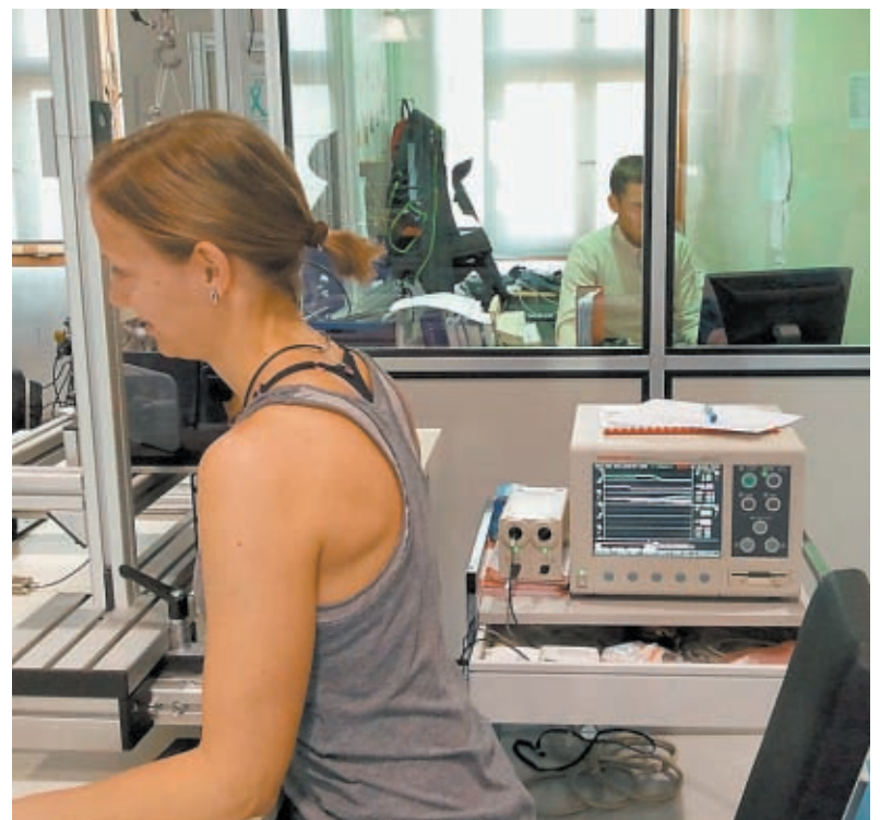
Über den Monitor eines Spezialgeräts wurden die Sauerstoffsättigungswerte in der Armmuskulatur überprüft. Fotos: Marc Philippe (3), Hofer
