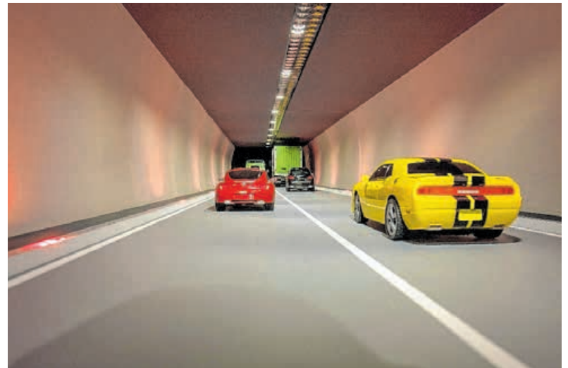
Das Tunnelmodell ist im Entstehen (links im Bild). Am fertigen Modell bei der Firma Bartenbach können alle Beleuchtungsvarianten im Tunnel simuliert werden.
