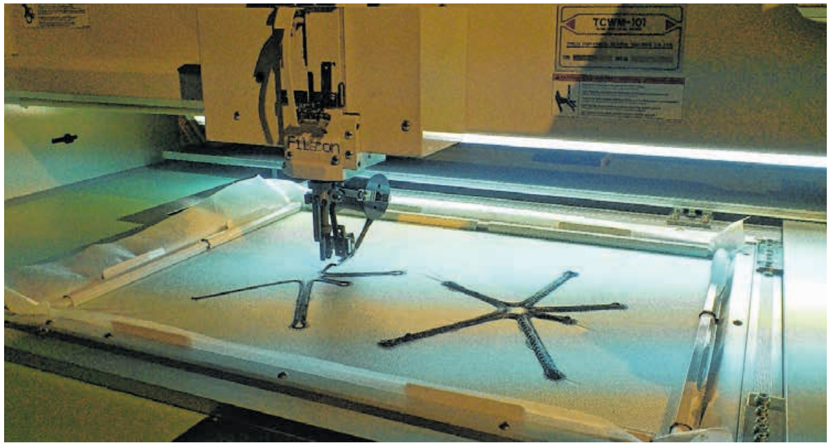
Die Fasern werden auf ein Trägermaterial gestickt.
