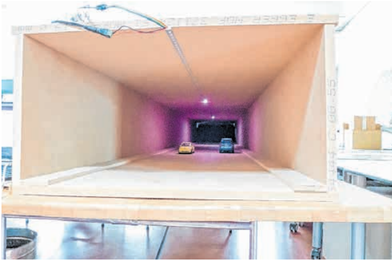
Das Tunnelmodell ist im Entstehen (links im Bild). Am fertigen Modell bei der Firma Bartenbach können alle Beleuchtungsvarianten im Tunnel simuliert werden.
