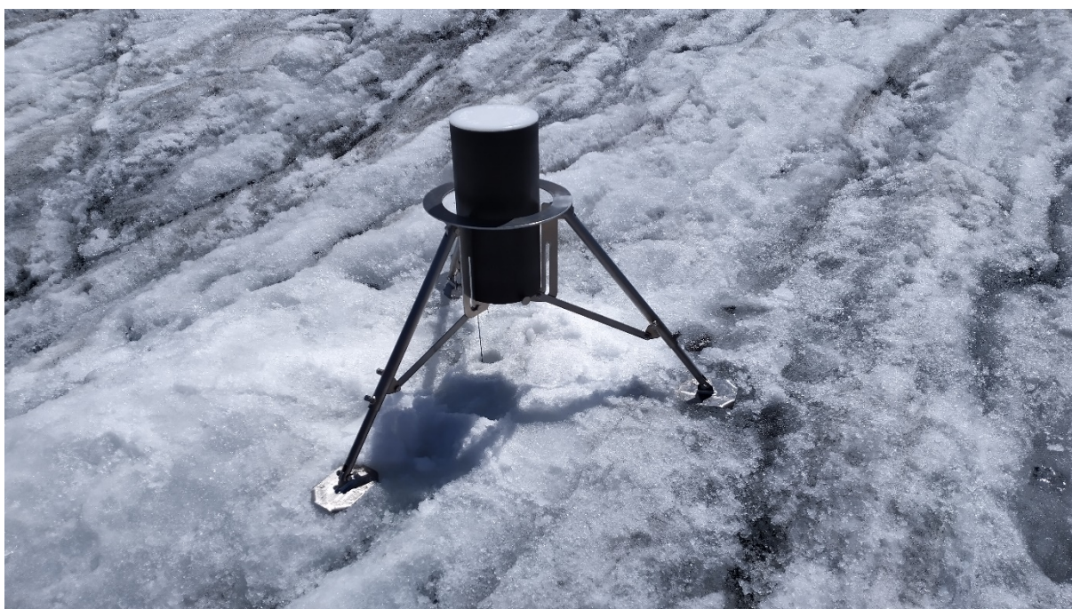
Abbildung 36: Der SmartStake nahe dem Lollipop (L5). Eine Schnur mit Gewicht am Ende wird bis zum Boden eines Bohrlochs (6 m) im Gletscher hinabgelassen. Bei Schmelze verringert sich die Distanz der Oberfläche zum Grund des Bohrlochs. Die Schnur wird locker, über eine Haspel aufgewickelt und diese Länge registriert. Foto: Rainer Prinz, 29.07.2021.
