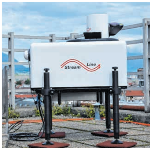
Mit Laserinstrumenten am Boden (li., hier auf dem Dach des Bruno-Sander-Hauses der Uni Innsbruck am Innrain in Innsbruck) und einem Flugzeug (re., hier am Flughafen Innsbruck) messen die Forscher die turbulenten Föhnwinde über dem Inntal.
