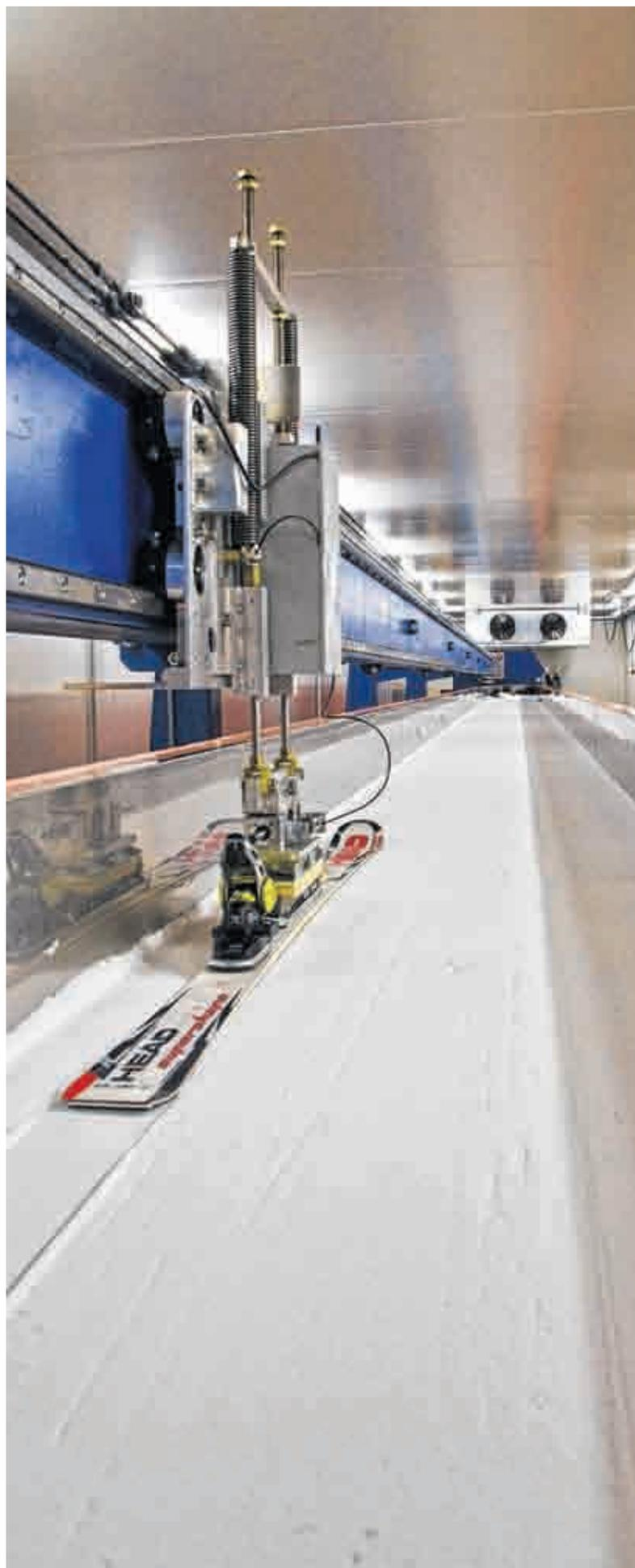
Mit bis zum 100 km/h rast der Ski auf einem Messschlitten über die speziell präparierte Schneeauflage.
