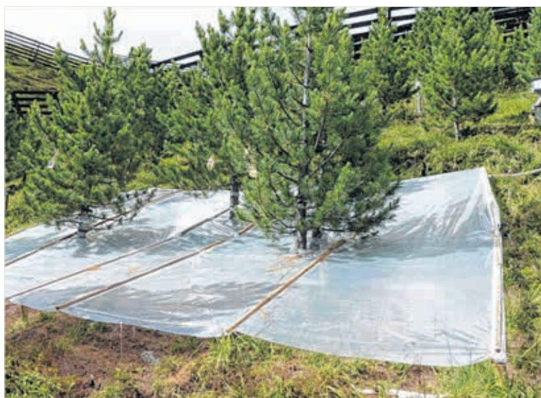
Mit Hilfe von „offenen Gewächshäusern“ (links) und einer Abschattung durch Folien (rechts) erreichten die Wissenschaftler auf den Testflächen Bodentemperatur-Unterschiede von rund 3,5 Grad Celsius.
