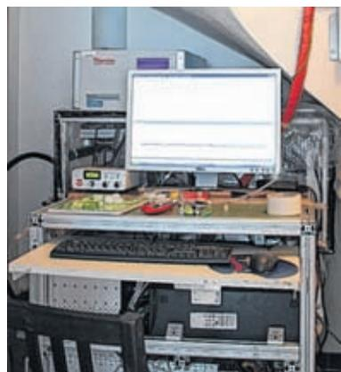
Mit einer Spezialvorrichtung konnte die Luft direkt aus der Atemzone von Ralf Schnitzhofer (r.) abgesaugt und über einen beheizten Teflonschlauch zum PTR-TOF-Massenspektrometer (l.) transportiert werden. Fotos: Schnitzhofer
