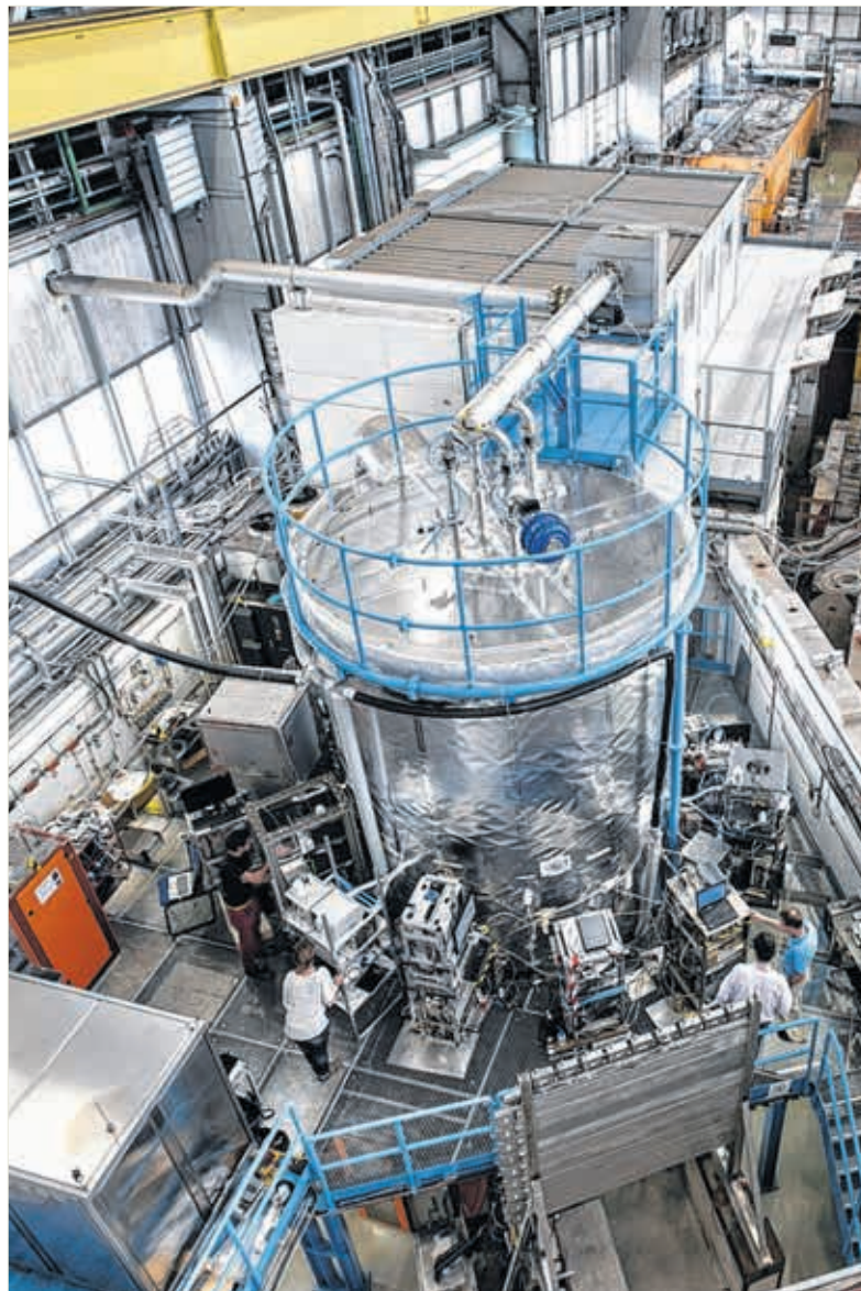
Die CLOUD-Kammer in einer Halle am CERN ist mit zahlreichen Messinstrumenten und einem speziellen Beleuchtungssystem ausgestattet. Foto: CERN
