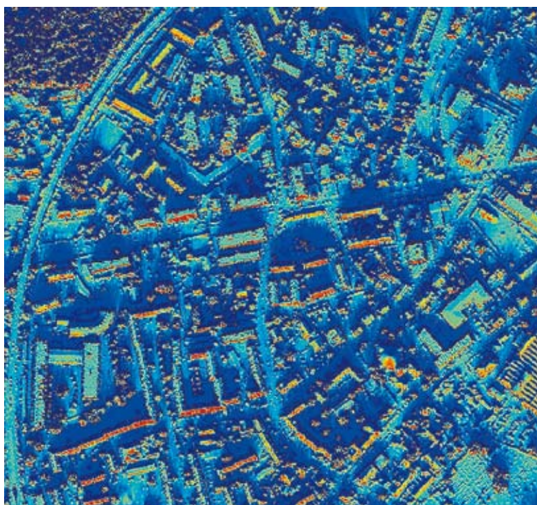
Die Dächer von Bregenz: Die roten Bereiche kennzeichnen Dächer mit hoher Sonneneinstrahlung.
