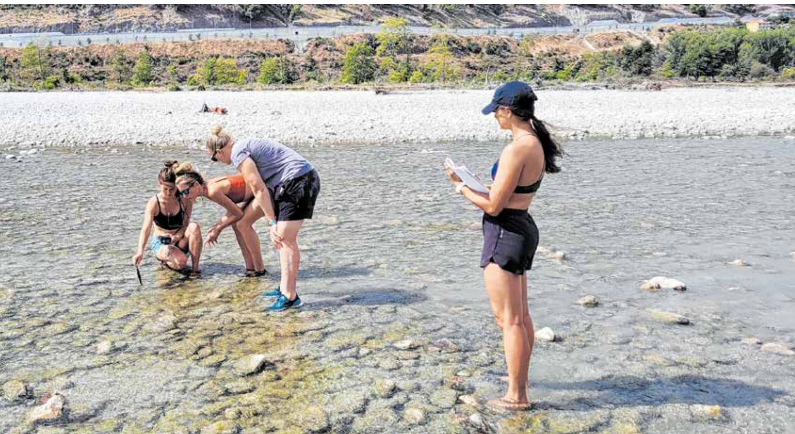
Thea Schwingshackl und Barbara Jechsmayr (v.l.) beim Platzieren eines Piezometers an der Hyporheischen Zone der Vjosa.
