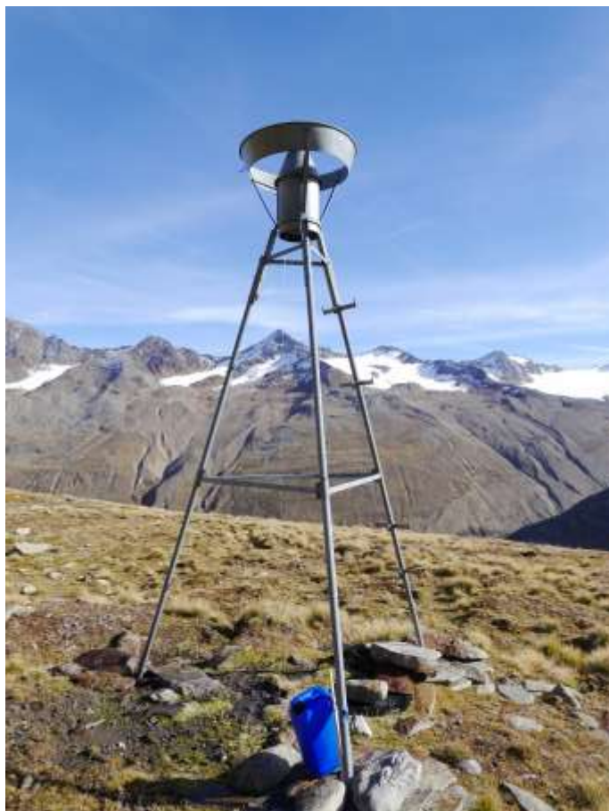
Abbildung 25: RM Proviantdepot am 28.09.2016. Nach der Befüllung mit Salz leckt der RM. Foto: Mathias Dusch.
