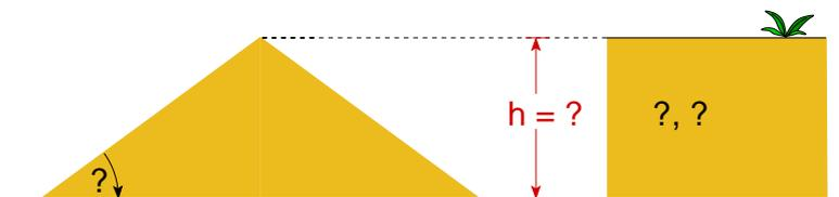
Abbildung 1: Welche Parameter sind maßgebend dafür, wie steil ein Hang abgeböschet werden kann?
