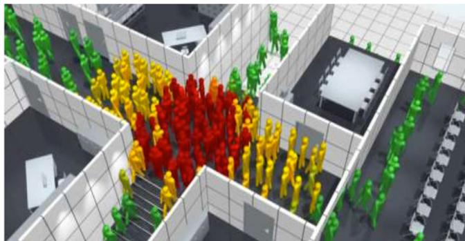
Abbildung 5.3-3: Beispiel einer Simulation zum Fluchtverhalten von Personen (aus [42])
