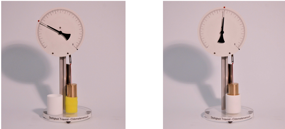
Abbildung 2: Verformungen mit und ohne behinderte Seitendehnung
