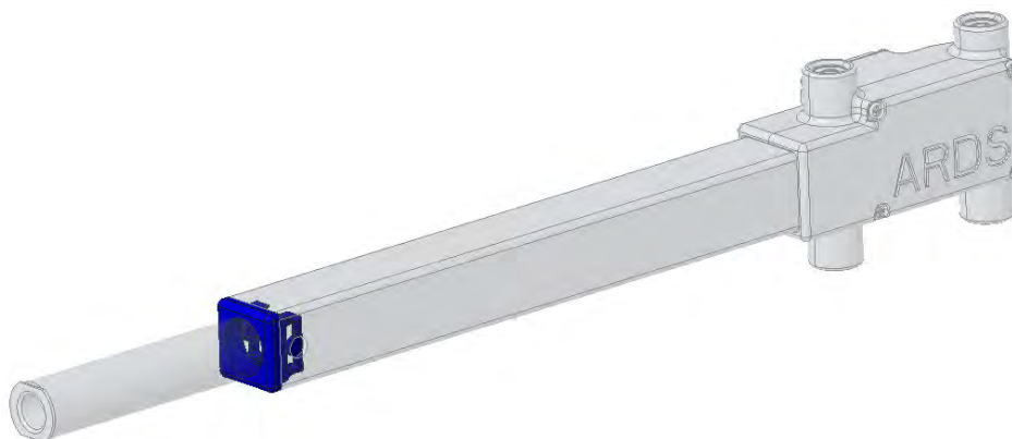
Abbildung 3.25: Aktuatorführung mit verringertem Spiel.
