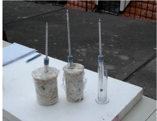
Isolationsversuch mit verschieden dicht gepackten Federn. Foto: Waltraut Buchinger
