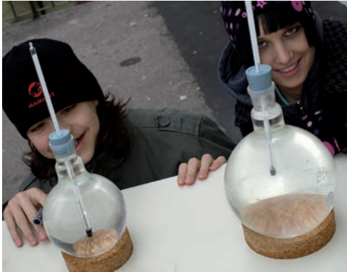
Versuch zum Nachweis der Bergmann'schen Regel: Größenabhängigkeit des Wärmeverlustes. Foto: Waltraut Buchinger
