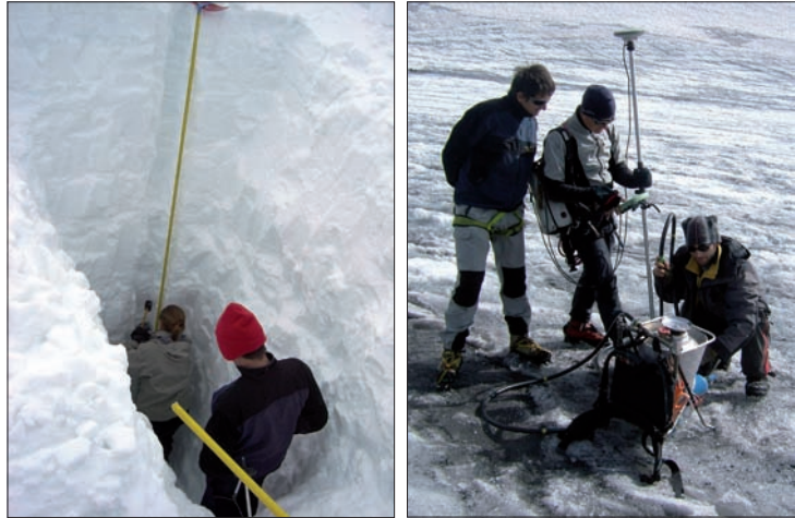
Abb. 34. Feldmessungen auf den Gletschern. Links: Schneedichtemessung in einem Profil der Winterschneedecke (Foto G. Weyss). Rechts: Setzen eines Ablationspegels mit Dampfbohrer und GPS-Antenne (Foto B. Hynek)
