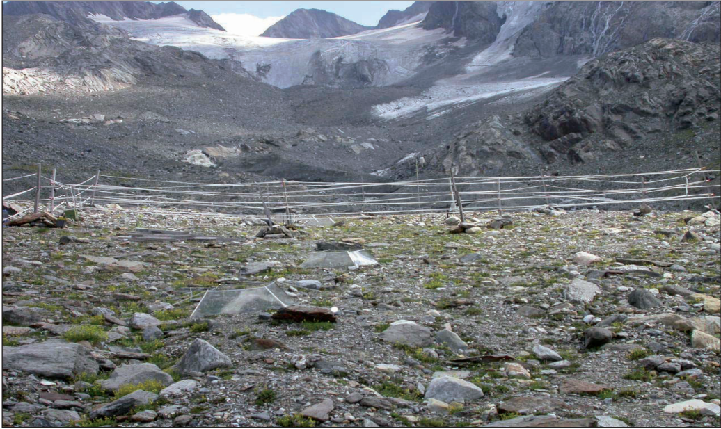
Abb. 1: „Mini-Gewächshäuser“ (open top chambers) – oben und unten offen – bewirken eine 1,0 bis 1,5 °C höhere Bodenoberflächentemperatur und simulieren damit ein Minimum-Szenario der Temperaturerhöhung im Alpenraum (Gletschervorfeld des Rotmoosferners, Obergurgl, Ötztal).
