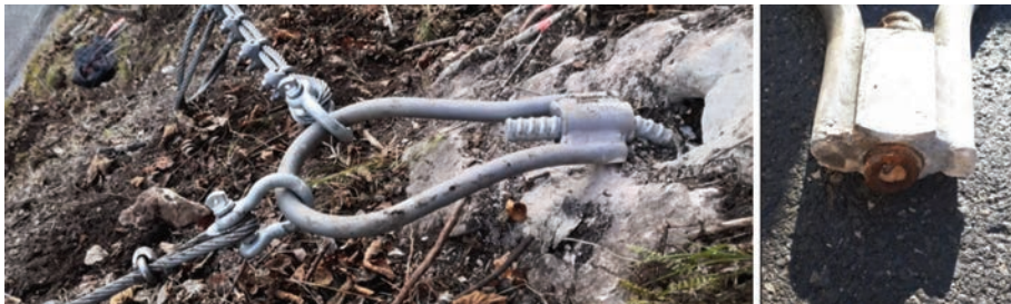
Abbildung 2: Verformtes und gebrochenes Tragglied (ÖBB)
