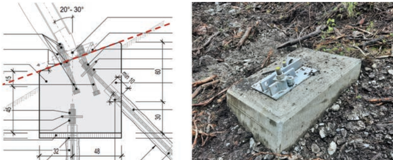
Bild 3, (a) Ausschnitt Normalien RhB Foundation, mit Sollbruchstelle ab Grundplatte (b) Foundation RhB erstellt 2023
