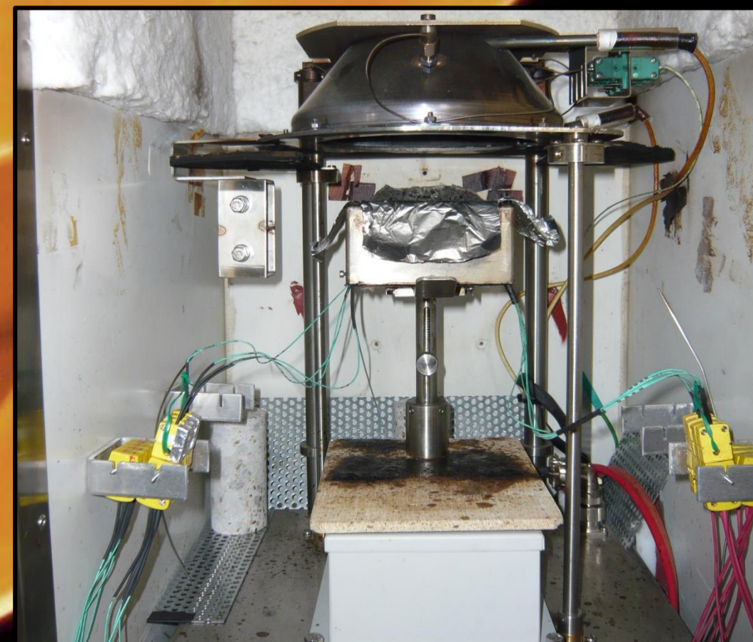
Abbrandrate unter einer Belastung nach der ETK
