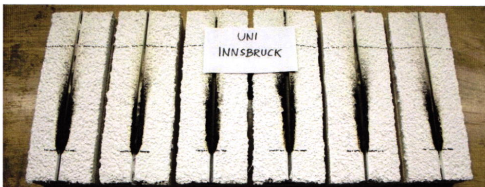
Bild 2: Probekörper mit APU Aufsteckprofilen und vorkomprimierten Fugenbändern nach der Flächenbeflammung
