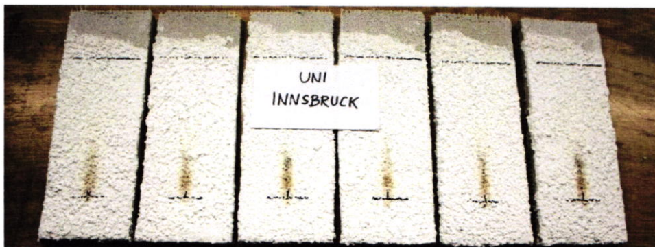
Bild 4: Probekörper mit Standard-Putzoberfläche nach der Flächenbeflammung
