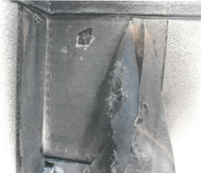
Bild 11: Detailaufnahme nach Versuchsende – Blick auf die Putzträgerplatte nach Entfernung des Putzes
