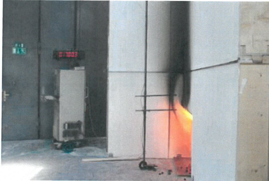
Bild 7: seitliche Übersichtsaufnahme in der 18. Versuchsminute – Die Brandlast der Krippe geht zurück, kein Mitbrand der Fassade mehr erkennbar
