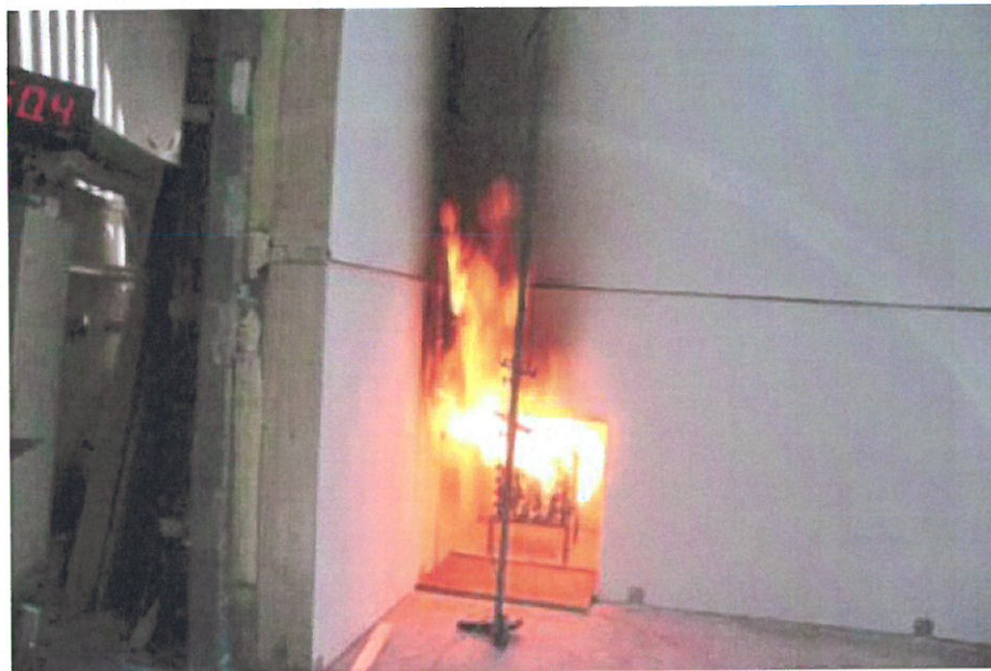
Bild 6: Übersichtsaufnahme in der 12. Versuchsminute – Mitbrand auch auf der Rückseite
