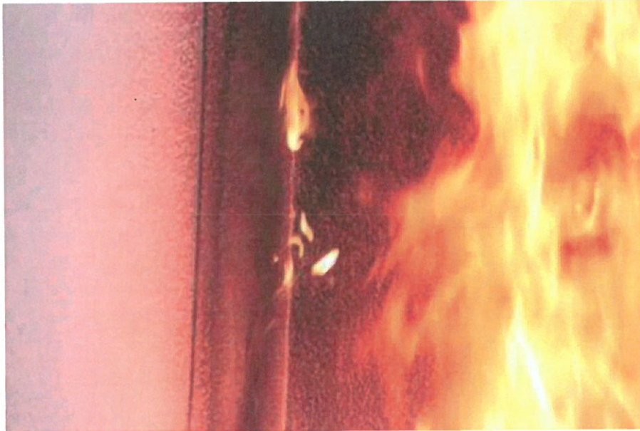
Bild 5: Detailaufnahme in der 10. Versuchsminute – Riss des Putzes in der Seitenwand, leichter Mitbrand der Fassade
