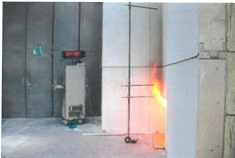
Bild 4: Seitliche Übersichtsaufnahme in der 5. Versuchsminute – Flamme berührt die Fassadenfläche, Verfärbung des Putzes
