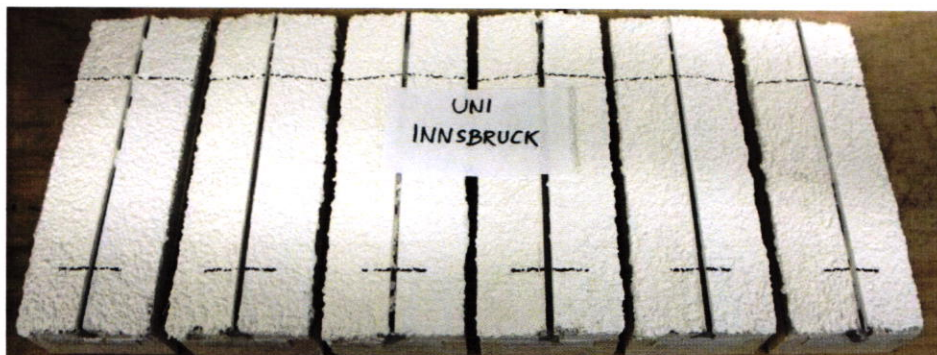
Bild 1: Probekörper mit APU Aufsteckprofilen und vorkomprimierten Fugenbändern vor der Flächenbeflammung
