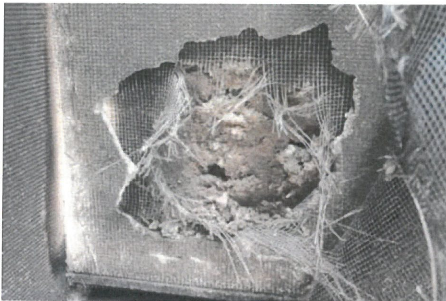
Bild 12: Detailaufnahme nach Versuchsende – Blick auf die Dämmung nach Entfernung der Putzträgerplatte
