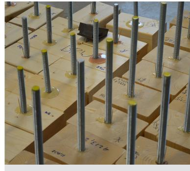
VERBUNDBAUTEILE SCHRAUB-PRESSKLEBUNG HOLZ-STAHLVERBINDUNGEN
