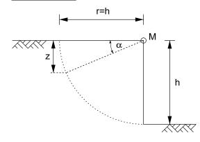
Für eine senkrecht Böschung in einem Material mit  $\gamma$ , c und  $\varphi$  wird ein Gleitkreis als Versagensmechanismus angenommen.
