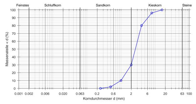
Für den Einbau in einem Damm sollen 250 Tonnen Material mit der dargestellten Kornverteilungslinie aus Korngrößenbereichen eines in einem Steinbruch gewonnen Materials zusammen gemischt werden. Im Steinbruch werden dieselben Maschenweiten für die Siebe wie im Geotechniklabor verwendet. Die Bezeichnung für einen Korngrößenbereich ist damit z.B. 1-2 mm.
