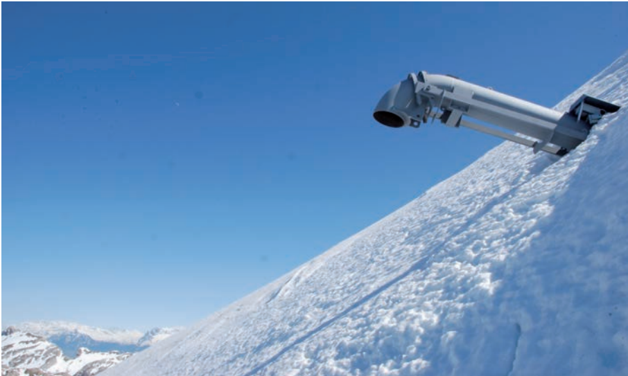
Bild 2 Beispiel einer Schutzsystems zur künstlichen Auslösung von Lawinen: System GazEx. Quelle: Fa. Interfab
