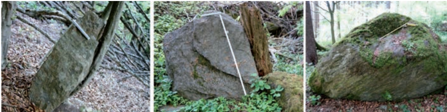
Abb. 7: Stumme Zeugen mit verschiedenem Alter; links: frisch, Mitte: angewittert, rechts: alt, starker Bewuchs (Preh, Mölk & Illeditsch 2020)
