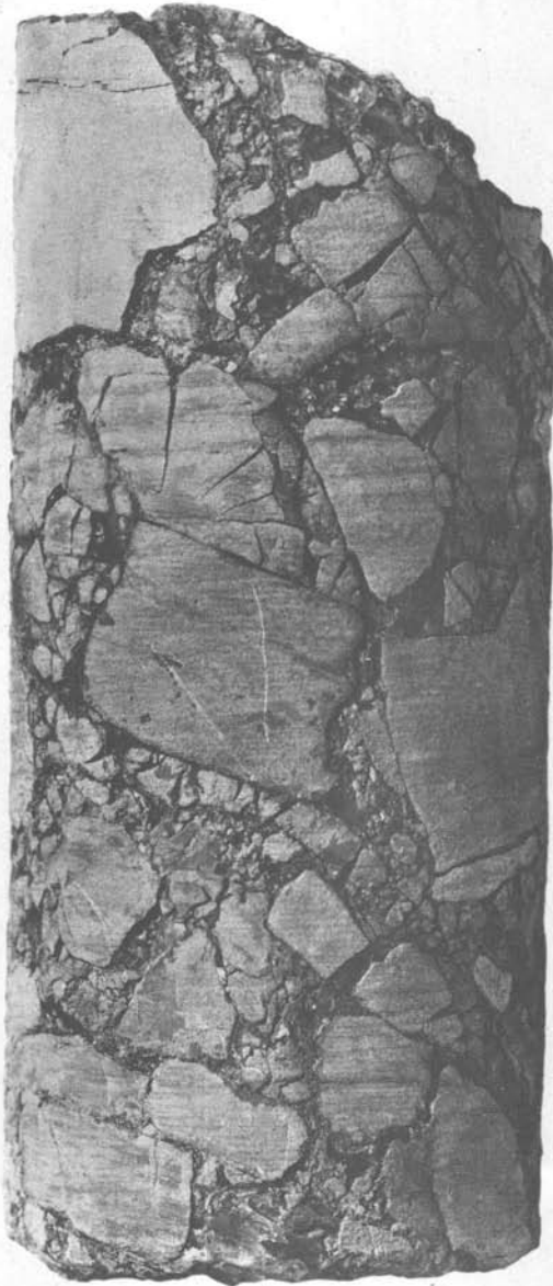
Salzmylonit: Muschelkalk im Zechsteinsalz. Bohrkern aus einem Kalibergwerk an der unteren Aller. (Nach E. Harbort.)
