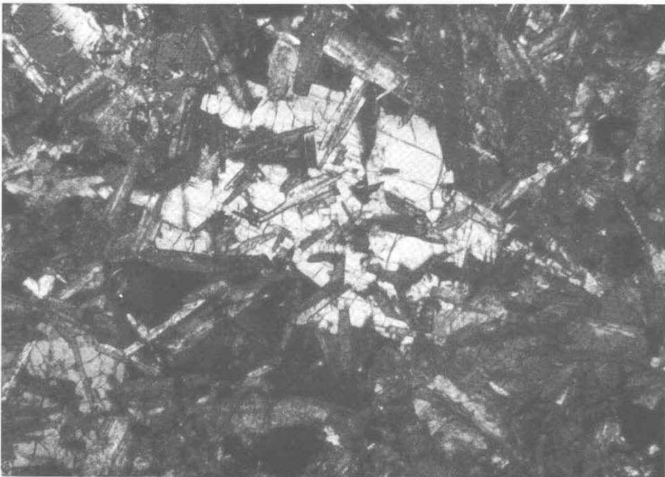
Abb. 2: Ophitische Textur im Diabas des Erzgrabens. Kpx I mit albitisierten Plagioklasleisten. 4 – Erzgraben, gekreuzte Nicols, Bildbreite ca. 1.55 mm.
