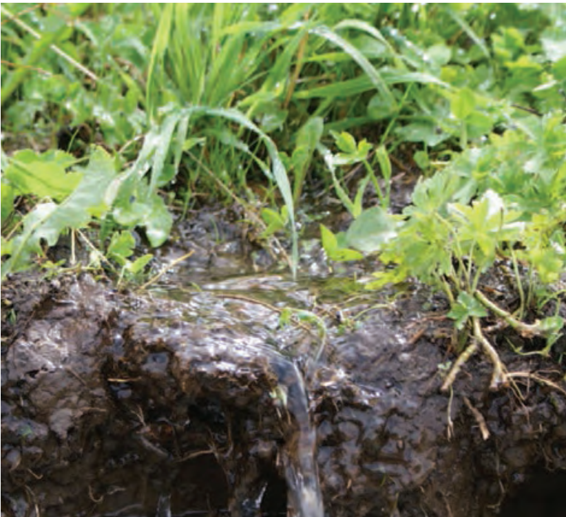
Beregnungsversuch: Die Entstehung von Oberflächenabfluss, Foto: Romed Ruggenthaler
