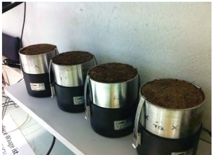
Messzylinder für die UMS Hyprob® Messung. Foto: Sebastian Gertloff
