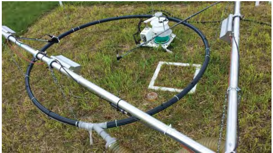
ClimGrass Versuchspartelle mit Begasungsring, Infrarotstrahlern, NEE-Rahmen und Bodenatmungskammer. Foto: David Reinthaler
