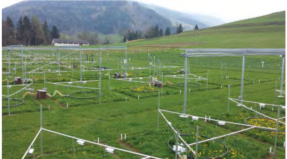
Versuchspartellen, in denen Effekte von Klimaerwärmungen im Grünland untersucht werden. Foto: David Reinthaler
