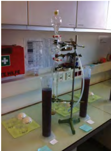
Schlämmanalyse der gesammelten Bodenproben im Labor. Foto: Sebastian Gertloff
