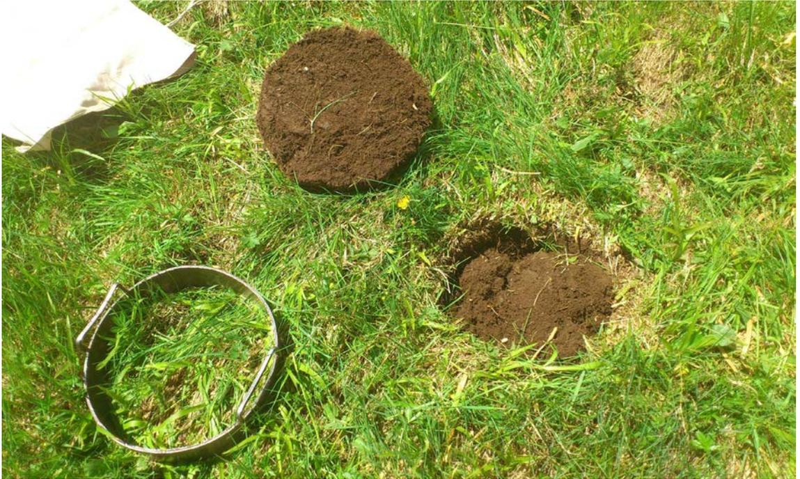
Bodenproben wurden mit einen 30 cm  $\varnothing$  Stecher und einem Spaten genommen.
