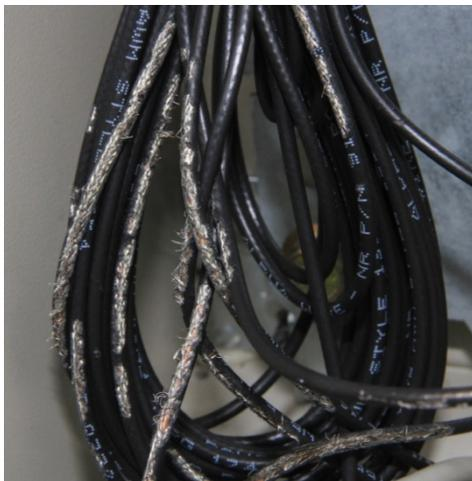
2015 war der Wartungs- und Instandhaltungsaufwand und die damit verbundenen Kosten geringer als im Vorjahr. Verbisschäden an der Verkabelung der Wetterstation an der Gletschermoräne von 1923 mussten repariert werden. Einige wenige defekte Messsensoren mussten ausgetauscht und die Dichtungen einiger Bodennaher Loggern erneuert werden.
